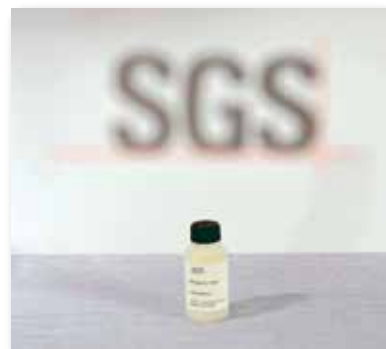
AL231: 100 ml plastflaska för analys av cyanid. Innehåller NaOH.
