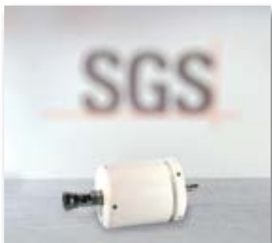
AL240: Filterhållare för analys av parasiter.
