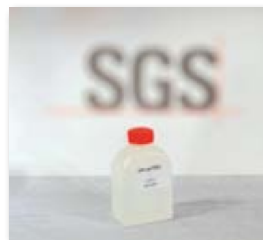
FKL500: 500 ml plastflaska för mikrobiologiska analyser i tryckluft. Innehåller 250 ml koksaltlösning.
