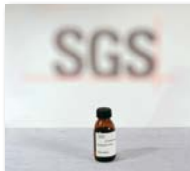
AL203: För analys av oljeindex. Innehåller HCl.
