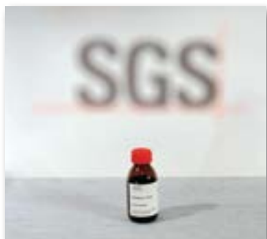
AL236: För organiska analyser. Innehåller H_2SO_4 .
